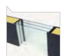
Standard 3 Scheiben Wärmeschutzglas (U Wert=0,5 - 0,6 W/m²K)
